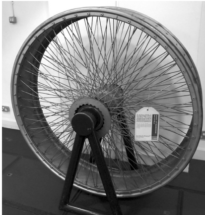
Abb. 2.8: Beispiel Flugzeugspeichenrad der Rohrbach Ro VI mit Aluminiumfelge von 1928. Durchmesser 2,20 m mit Bereifung (d. Verf.)
